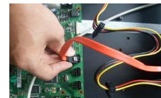
8. Connettere il cavo dati e richiudere i coperchio
