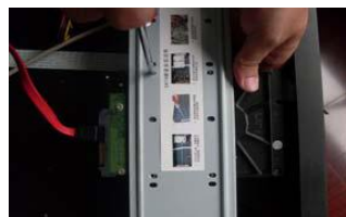
5. Fissare l'HD al supporto con le 4 viti
