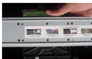
2. Svitare le viti della barra di supporto HD
