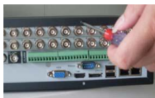
1. Svitare le viti nella parte posteriore del coperchio
