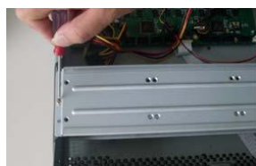
6. Rimontare la parte superiore della barra di supporto fissandola con le viti
