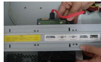
4. Allineare i fori dell'hard disk con i fori sulla barra
